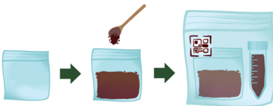
Figure 8: Procédure pour collecter l'échantillon de sol pour l'évaluation hors site des concentrations en métaux et en nutriments dans le sol
