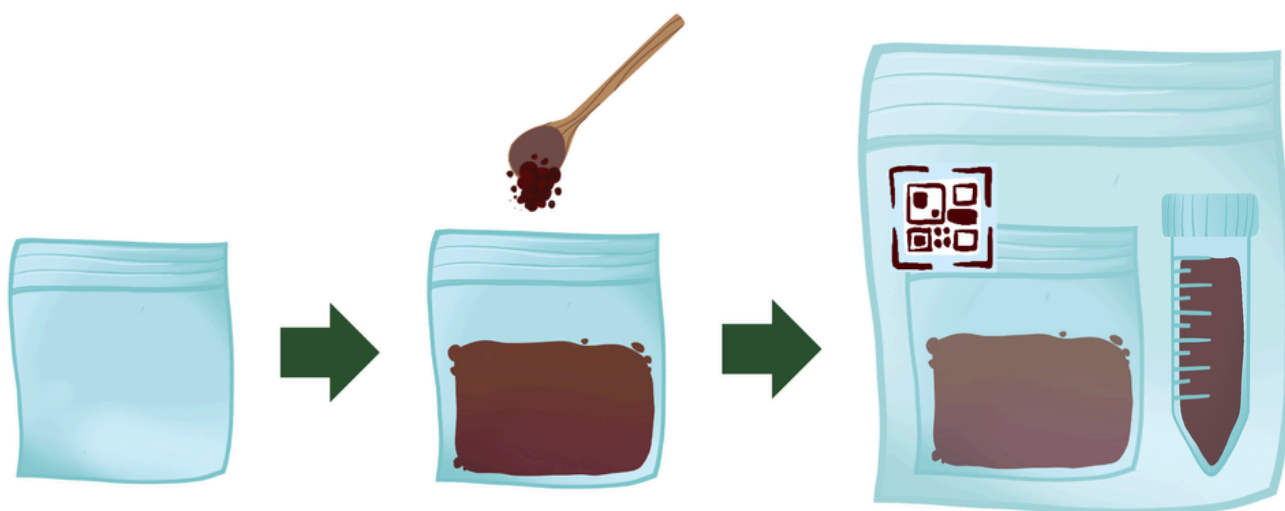
Figure 8: Procédure pour collecter l'échantillon de sol pour l'évaluation hors site des concentrations en métaux et en nutriments dans le sol
