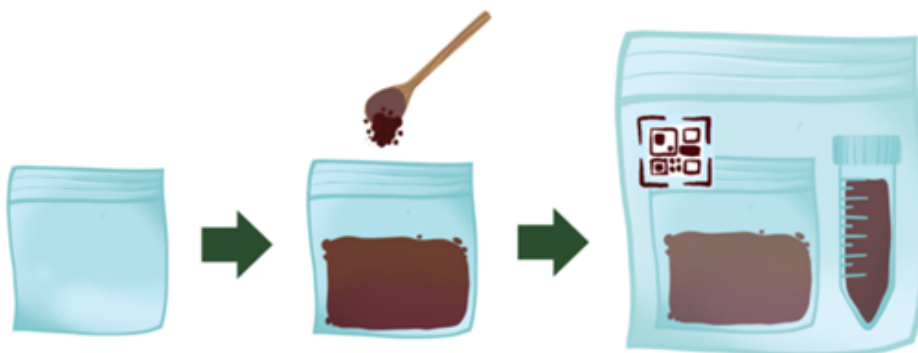
8 pav. Dirvožemio mėginio paėmimo procedūra, skirta sunkiųjų metalų ir maistinių medžiagų kiekiui įvertinti už objekto ribų
