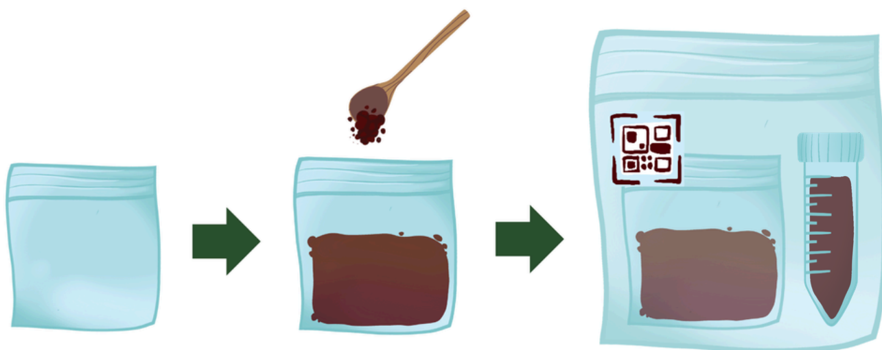
Figur 8: Jordprovtagningförfarande för bedömning av tungmetaller och näringsämnen utanför platsen
