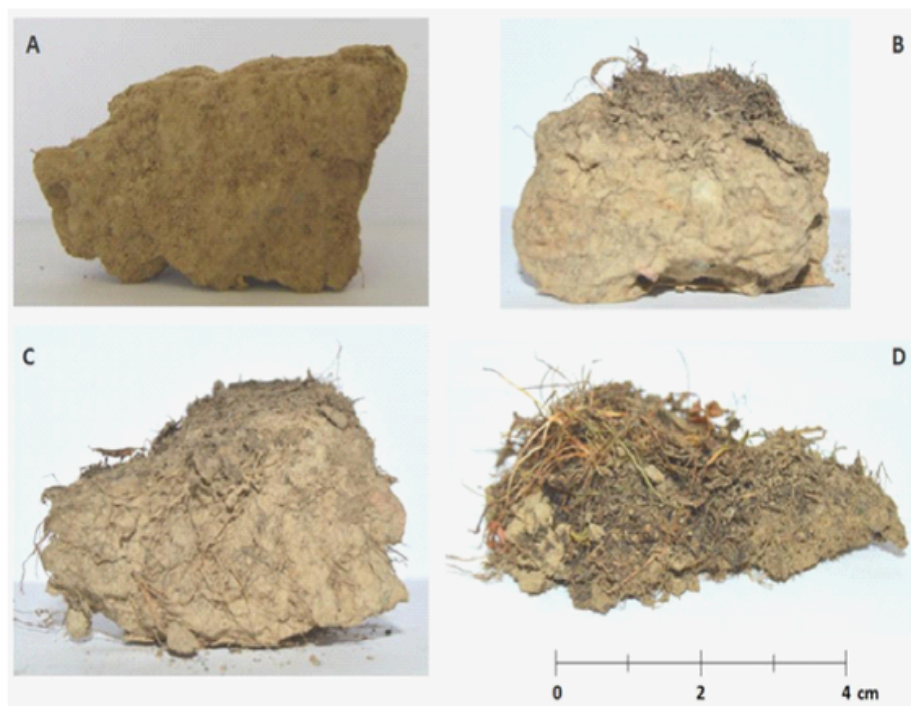
Esempi di alcuni tipi di struttura del suolo: A: massiccia, B: prismatica, C: a blocchi, D: granulare.
