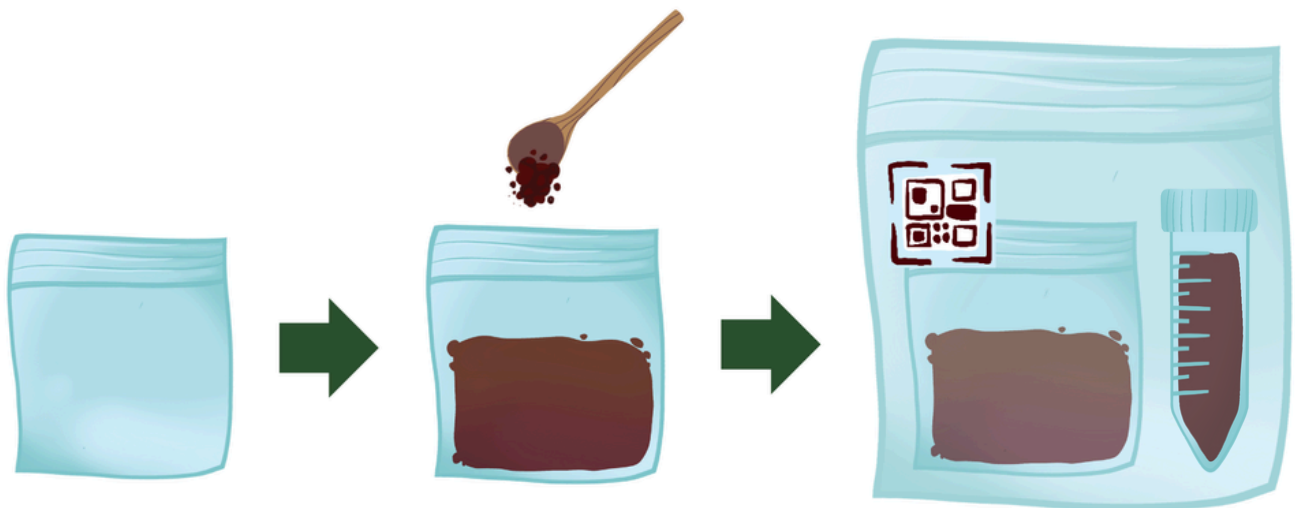
Figura 8: Procedimento para colher uma amostra de solo para avaliação de metais pesados e nutrientes (fora do local de recolha).
