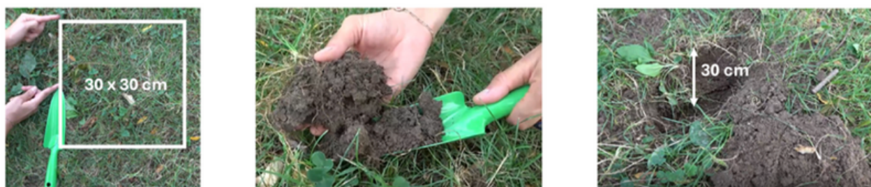
Figura 2: Escavação do solo.
