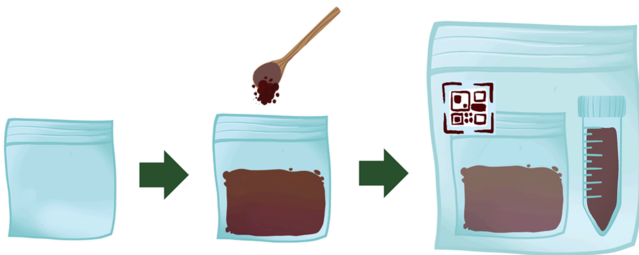
Figura 8: Procedimento para colher uma amostra de solo para avaliação de metais pesados e nutrientes (fora do local de recolha).
