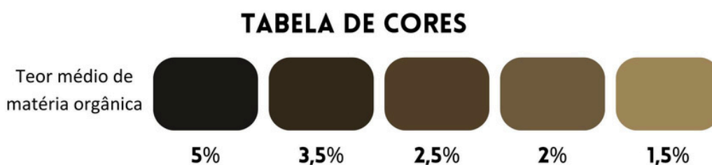
Figura 4: Carta de cores do solo para avaliar o seu conteúdo de matéria orgânica.
