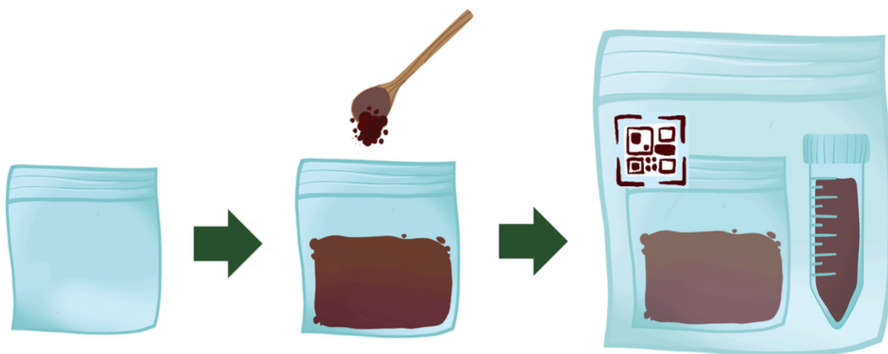
Figura 8: Procedura de colectare a unei mostre de sol pentru evaluarea metalelor grele și a nutrienților.
