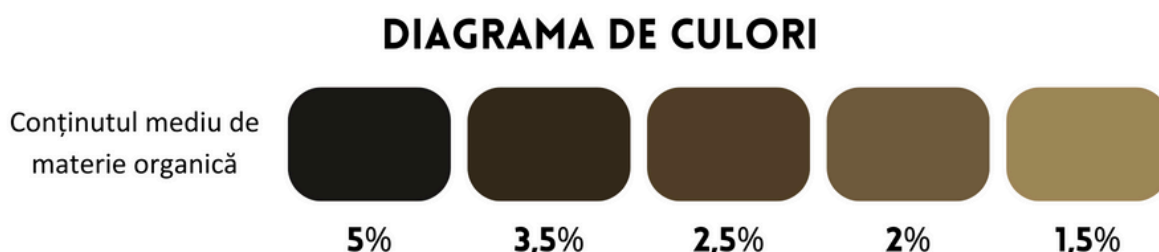
Figura 4: Diagrama coloristică pentru estimarea conținutului de materie organică din sol.
