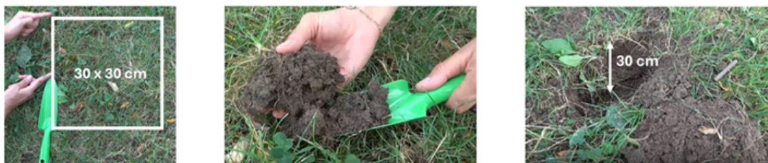
Abbildung 2: Ausheben des Bodens
