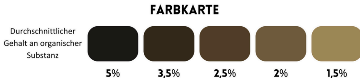
Abbildung 4: Farbkarte des Bodens zur Schätzung des Gehalts an organischer Substanz im Boden.
