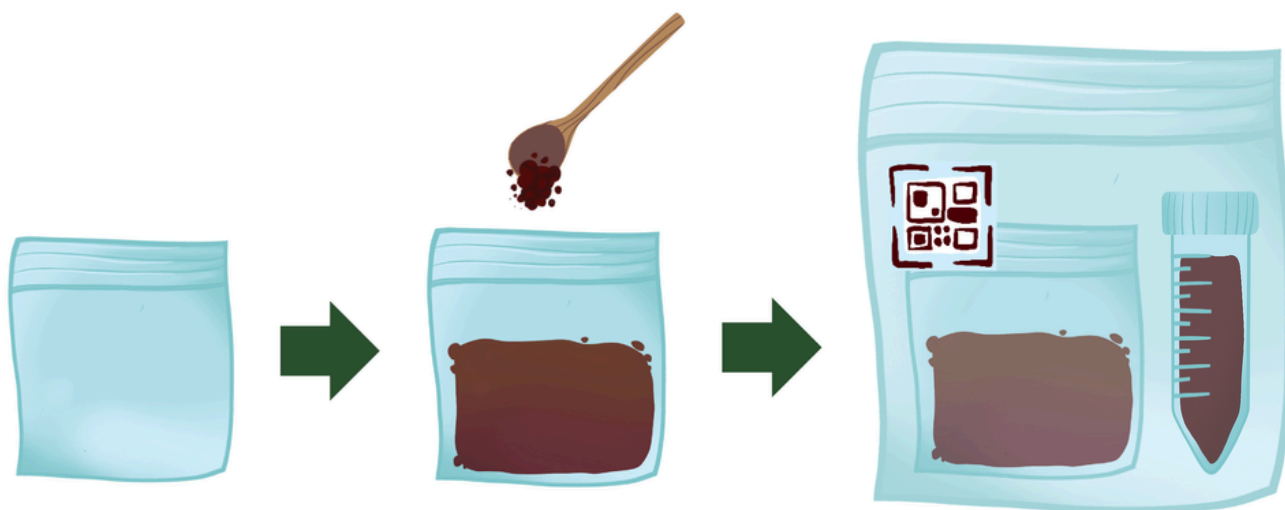
Figura 8: Procedura per raccogliere un campione di suolo per la valutazione dei metalli pesanti e dei nutrienti fuori dal sito di campionamento.
