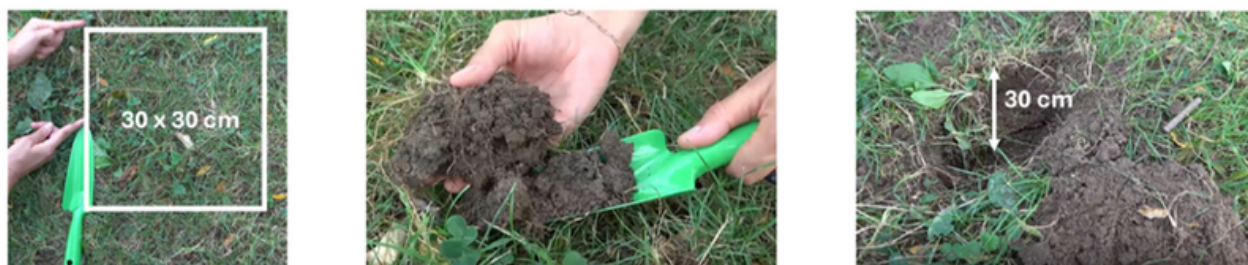
Figura 2: Excavación del suelo.
