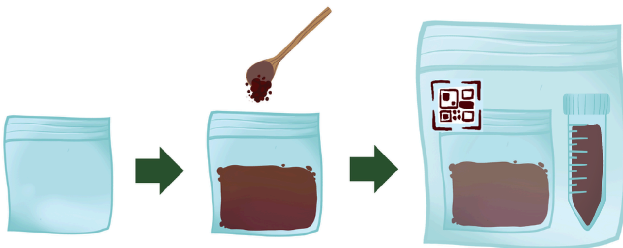
Σχήμα 8: Διαδικασία συλλογής δείγματος εδάφους για την αξιολόγηση των βαρέων μετάλλων και των θρεπτικών ουσιών εκτός του πεδίου.
